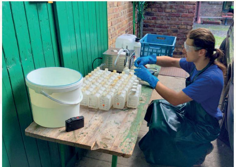
*Das jährliche Gekleckere beim „Abfüllen von Ameisensäure auf die Schnelle“ hat dank dieser Abfüllmaschine ein Ende.*
