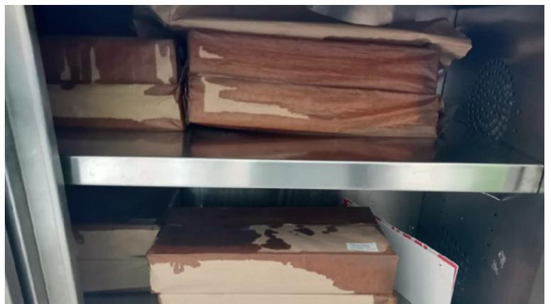
Abb. 4: Apropos aus Fehlern lernen: Die Mittelwände auf dem Foto sind infolge eines Defektes der eingebauten Temperatursteuerung zusammengeschmolzen. Wer also keinen Laborwärmeschrank, sondern wie hier einen Tellerwärmer nutzt, ist eine zusätzliche externe Temperaturüberwachung für etwa 25° gut beraten.
