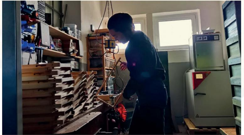
Abb. 2: Vor dem Einlöten werden die Drähte der Rähmchen mit einer Zange gespannt.
